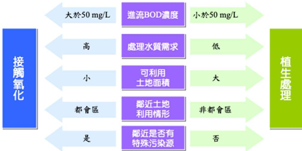
圖 76 現地處理工法適用選擇原則
