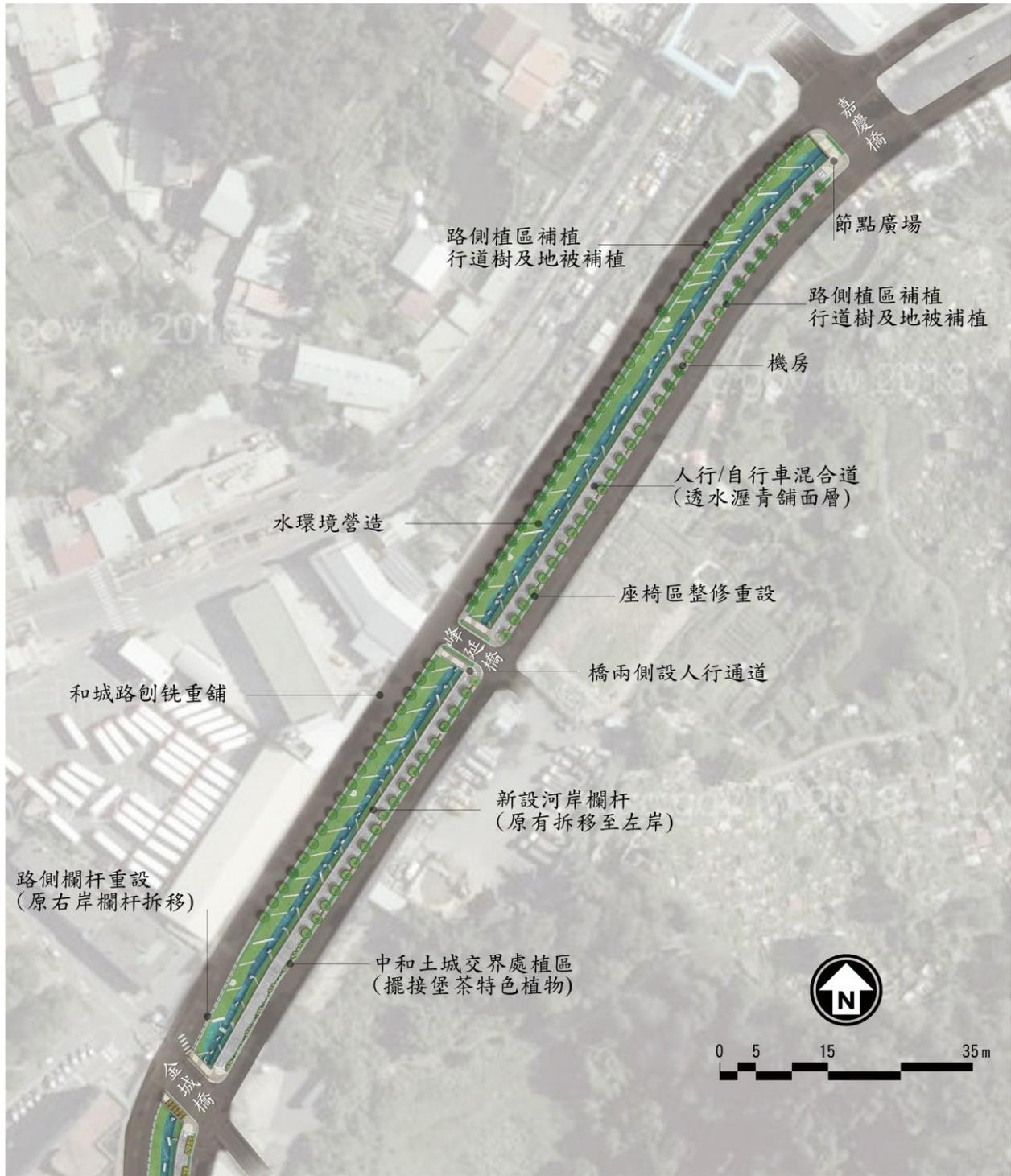
圖 5-33 水陸域工區下游段平面配置圖(嘉慶橋-金城橋)
