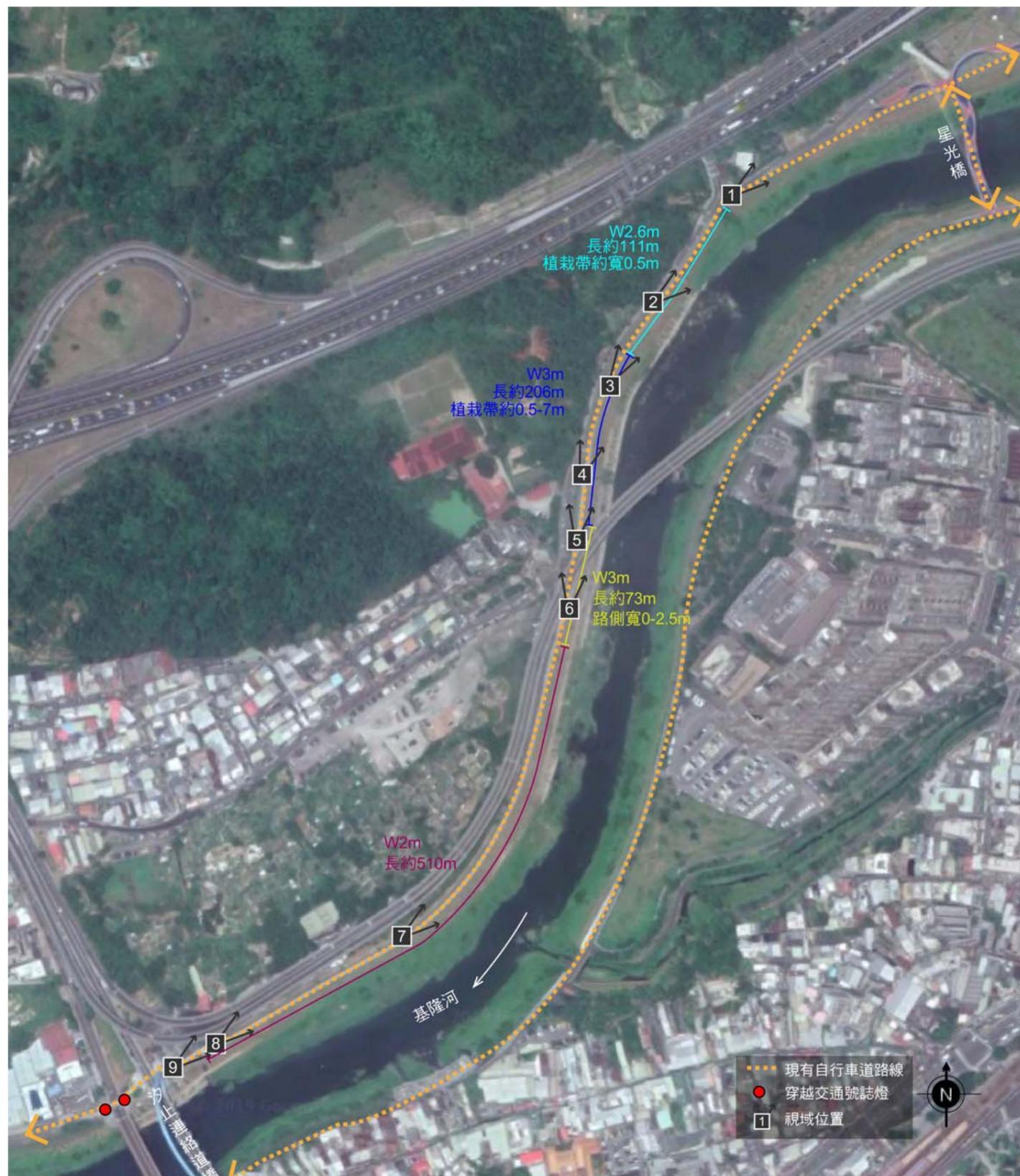
目前自行車道系統最小寬度 2m 至最大寬度 3.5m，設置寬度主要受限於現有堤頂空間大小，且車道側亦需留設景觀高燈設置空間，使汐止連絡道橋上游 510m 長之段落自行車道僅 2m 寬度。於接近星光橋側 111m 長之段落，為後期設置可移動式之植栽帶，主要做為緩衝空間，使原本 3m 寬之自行車道縮減為 2.6m，其餘路段自行車道皆有 3m 以上。
