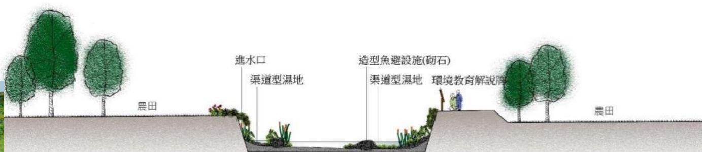
於河道兩端處設置渠道型濕地，過濾並淨化左右兩岸的排放水。透過砌石排列出特殊的水岸景觀，並可兼作大型緊急魚避設施使用。
