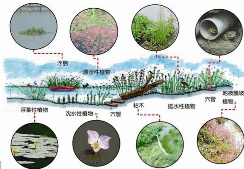
多孔隙及複層植栽搭配運用示意圖
