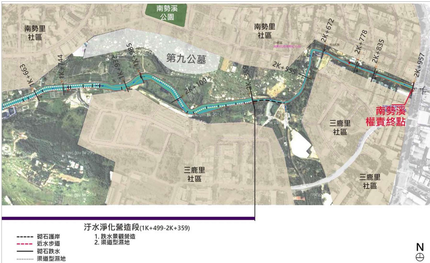
圖 15 南勢溪污水淨化營造段設施配置示意圖
