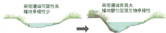
濕地兩側邊坡變化
