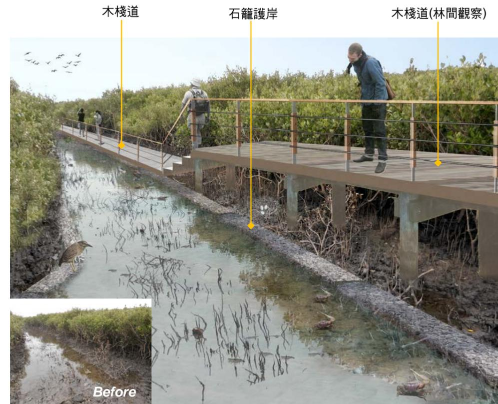
圖 7-16 高架步道及潮溝/石籠護岸示意圖 2
