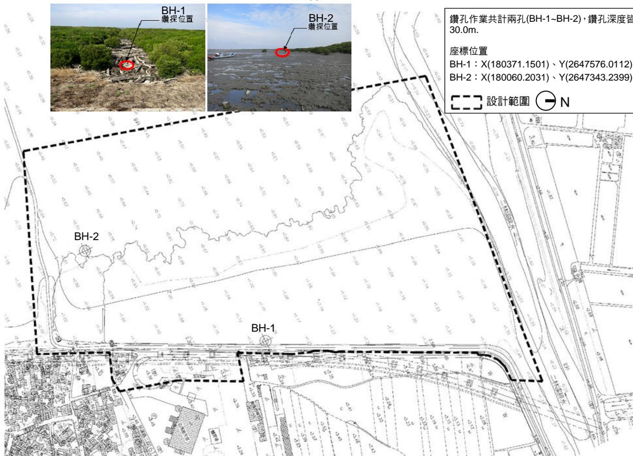
圖 4-5 地質鑽探孔位平面配置圖
