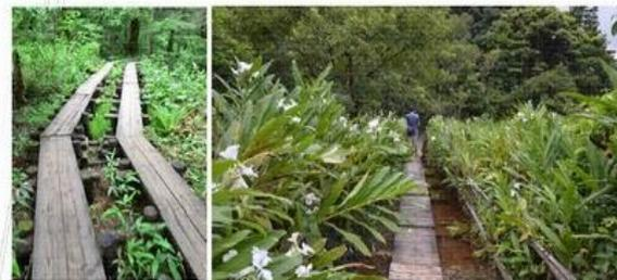
泥灘地步道以簡易、耐水淹(架高型棧道或固化土)之原則規劃
