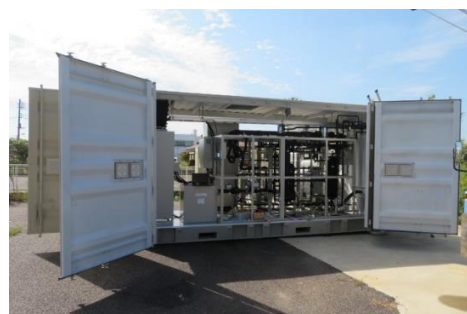
圖 2、電轉氣水電解產氫驗證設備
