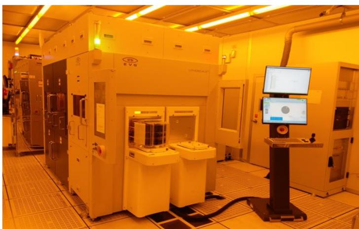
圖 1、12"高解析封裝製程雷射直寫曝光機
