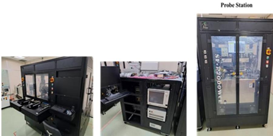
圖 5、晶片電測設備(IQC 功能測試)
