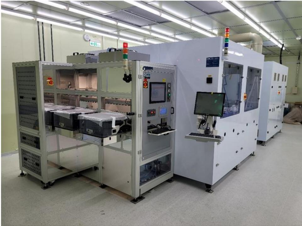
圖 7、異質整合封裝用晶片/晶圓清洗設備
