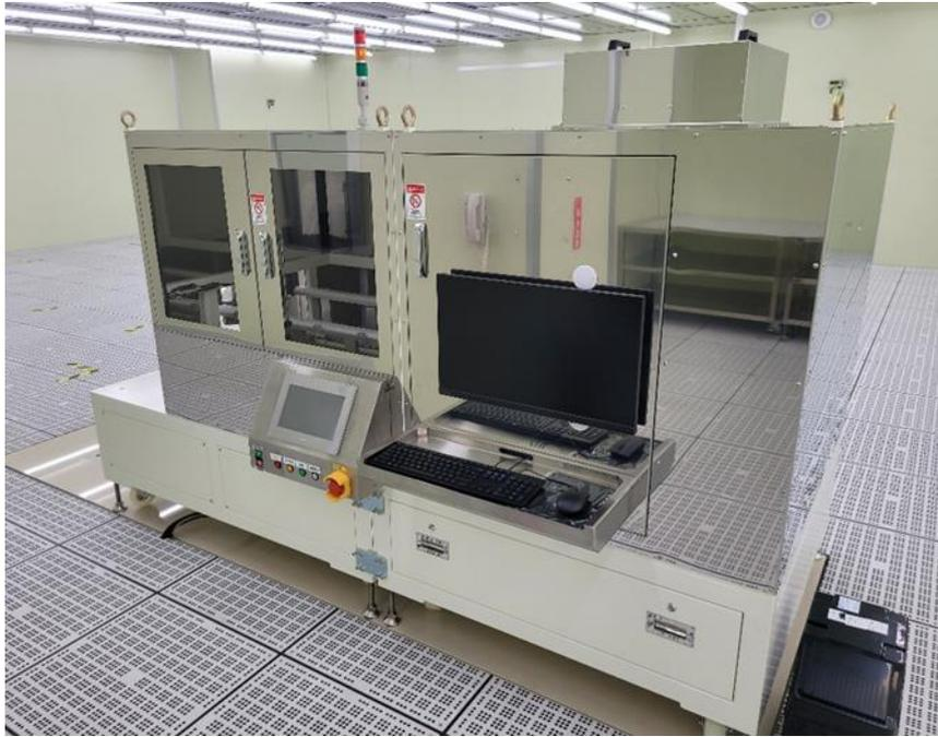
圖 6、晶粒/晶圓表面微粒檢測設備
