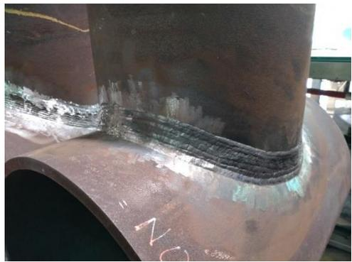
圖 3、靠船鋼管節點試作
