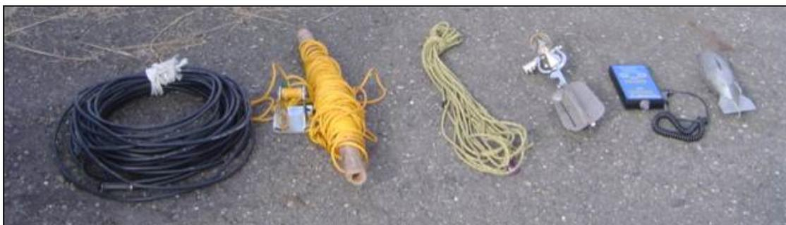
照片 3-1 旋杯式 622A 流速儀相關器具組
