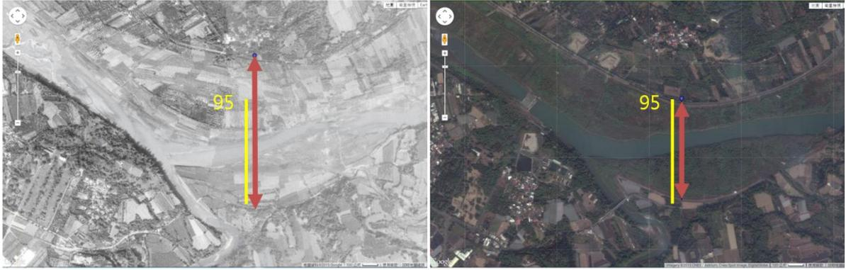
圖 1-32 二溪大橋下游河段河槽變遷比較圖(左：1974，右：2015)
