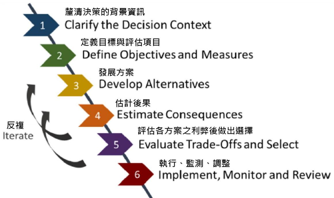
圖 4-2 結構決策系統的步驟
