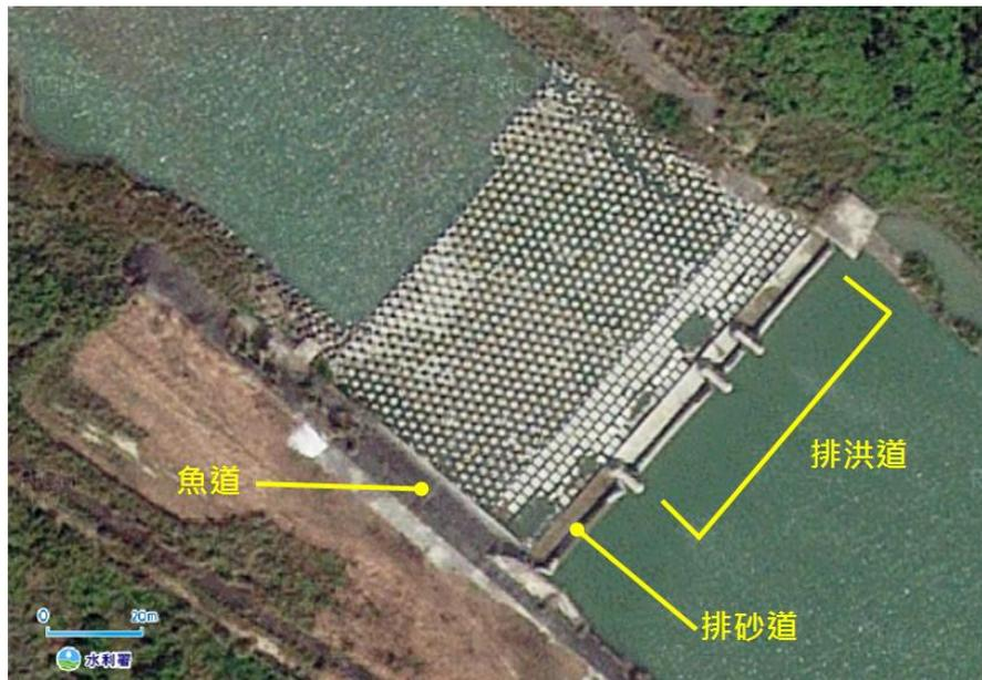
圖 5-13 2012 年 3 月衛星影像，顯示玉峰堰左岸魚道未發揮功能
