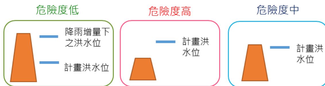
圖 5-9 堤防現況高度危險度評估示意圖
