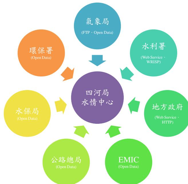
圖2-2 第四河川局自動化防災應變作業及決策輔助系統介接系統圖
