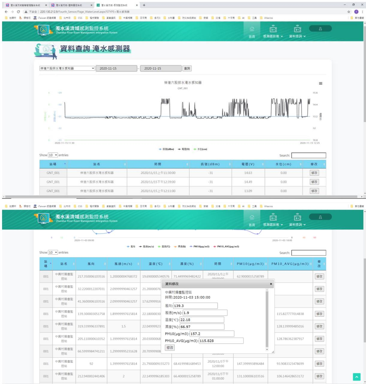
圖4-12 感測監控\_感測器資料查詢編修功能展示畫面
