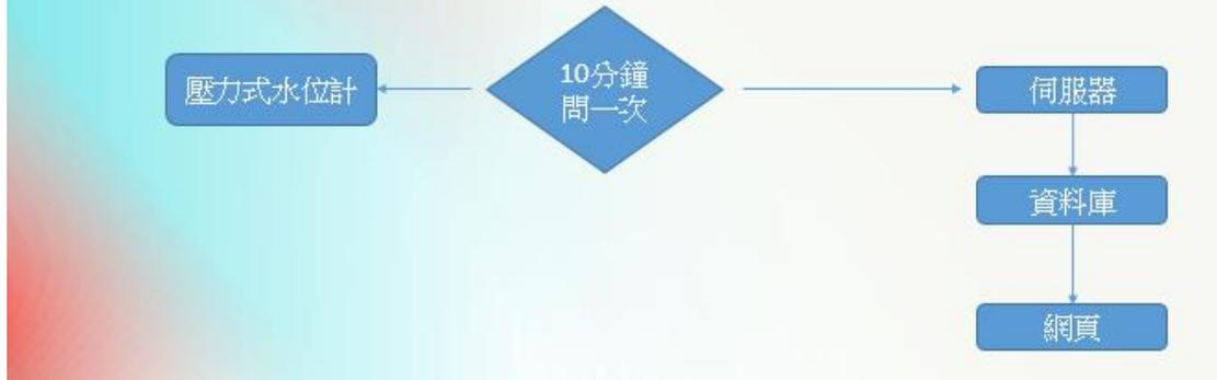
圖 11 彰化易淹水地區防汛熱點路面淹水感知器之資訊流程圖
