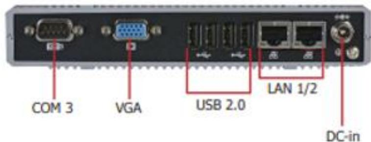
將螢幕接在紀錄器 VGA 上面，滑鼠鍵盤接在 USB 上面
