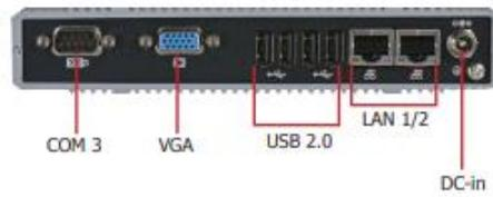
將螢幕接在紀錄器 VGA 上面，滑鼠鍵盤接在 USB 上面
