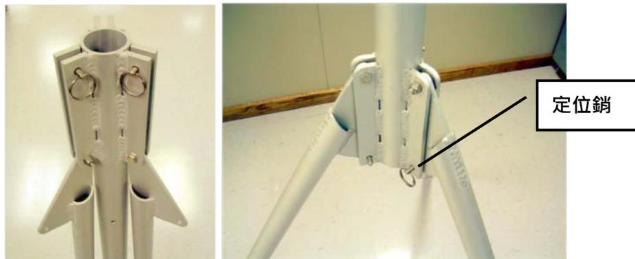
**2.將 E-BAM 安裝到三腳架上：**提起 E-BAM 組件，然後將 E-BAM 背面的插槽滑過三腳架頂部的卡榫。將提供的 $\frac{1}{4}$ -20 螺栓穿過 E-BAM 底部的卡舌並穿過三腳架主體的孔。用提供的墊圈和螺母固定。這防止 E-BAM 在三腳架上移動。
