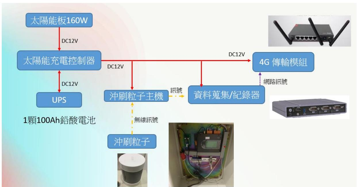
圖 10 既有危險潛勢堤段沖刷監測系統(電源、通訊)架構圖
