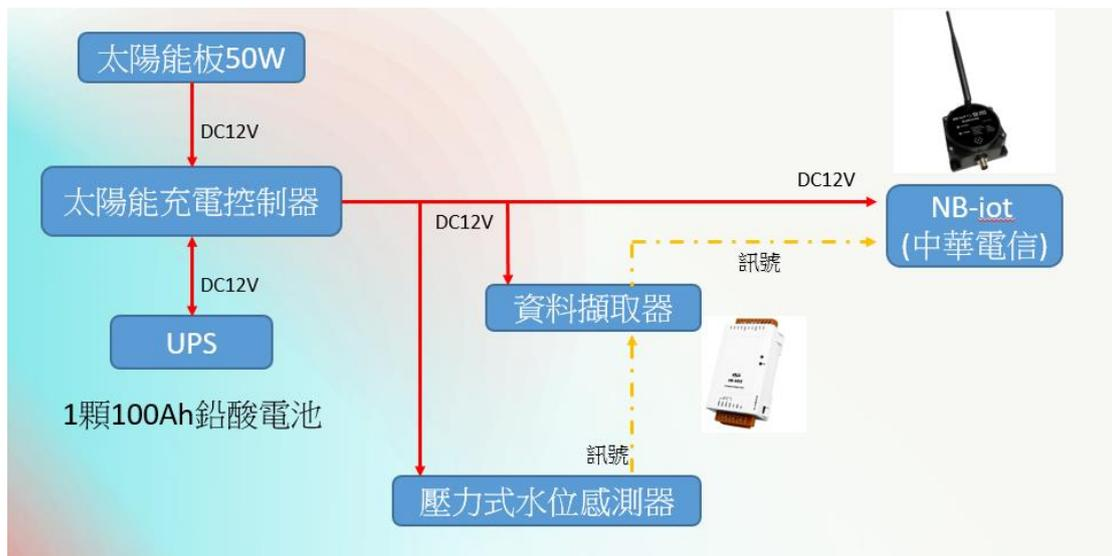
圖 10 彰化易淹水地區防汛熱點路面淹水感知器系統(電源、通訊)架構圖
