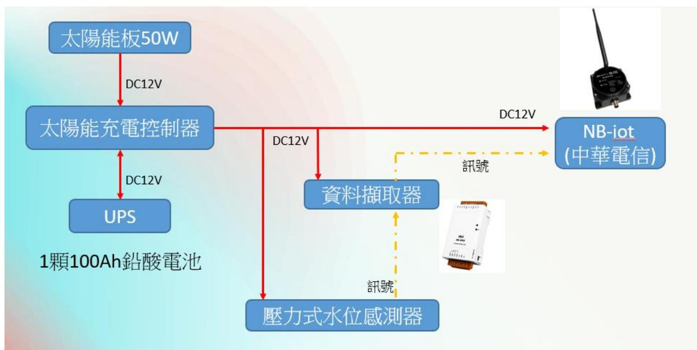
圖 6 彰化易淹水地區防汛熱點路面淹水感知器系統(電源、通訊)架構圖
