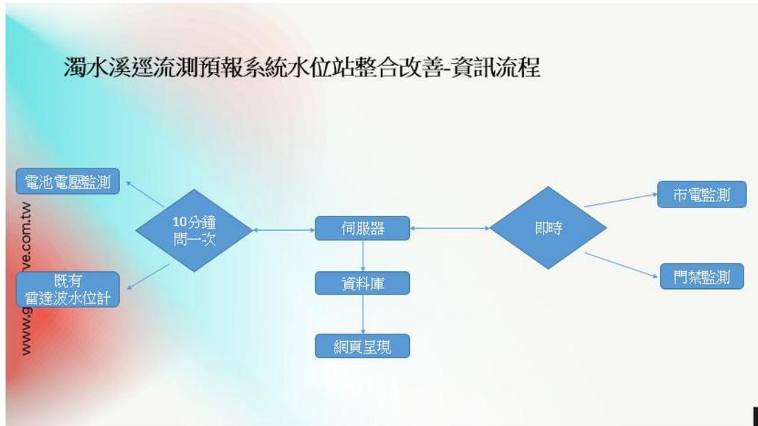
圖 3 濁水溪逕流測預報系統水位站整合改善之資訊流程圖
