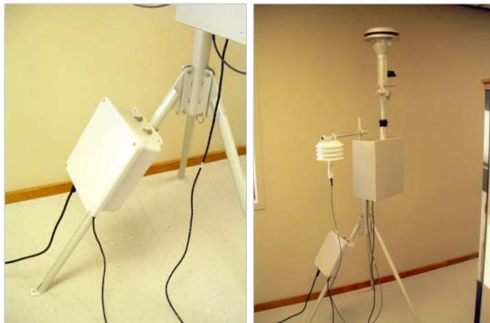
**7.選配氣象(MET)感測器：**如果 E-BAM 與其他選配氣象感測器（例如環境 RH 或氣壓感測器）一起提供，則它們連接到橫臂並插入與溫度感測器相同的連接器，使用提供的分離接頭框。
