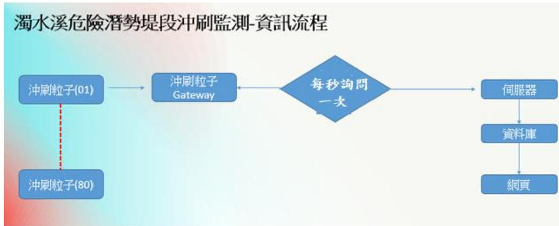
圖 17 濁水溪危險潛勢堤段沖刷監測之資訊流程圖
