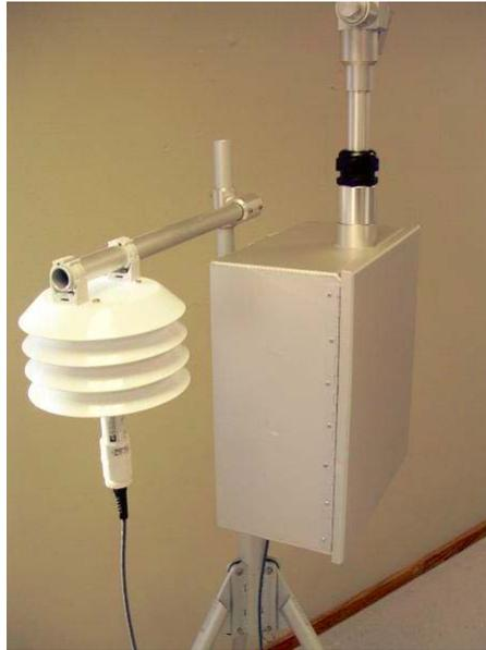
**5.選配風力感測器：**如果提供選配 EX-034 風速/風向感測器，那麼它將使用更長的橫管，而不是隨溫度感測器提供的短管。將風力感測器安裝在橫管的一端，溫度感測器安裝在另一端。風感測器應盡可能遠離 E-BAM 儀器，風標必須能夠完全旋轉而不會碰到任何東西。將風感測器插入 E-BAM 底部的相應連接器。感測器需要朝向北方。請參閱 034 風感測器附帶的單獨手冊。
