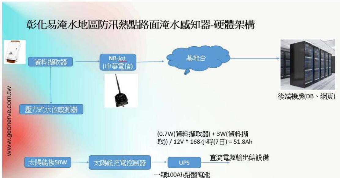
圖 9 彰化易淹水地區防汛熱點路面淹水感知器系統(硬體配置)架構圖
