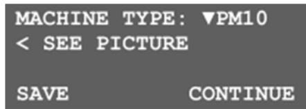
MACHINE TYPE 簡單地告訴 E-BAM 所配備的採樣口類型，PM<sub>2.5</sub> 或 PM<sub>10</sub>。兩者之間的唯一區別是 PM<sub>2.5</sub> 旋風採樣頭是否安裝好。E-BAM 會將機器類型設定放入數據數組，以便您可以判斷收集的數據是 PM<sub>2.5</sub> 還是 PM<sub>10</sub>。顯示頁面將指示使用者查看位於 E-BAM 門內的圖片，以便於識別兩種可能的採樣口類型。
