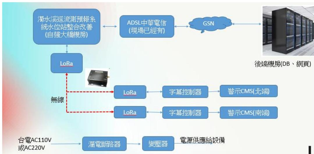
圖 11 重要橋梁水位警示系統(硬體)架構圖
