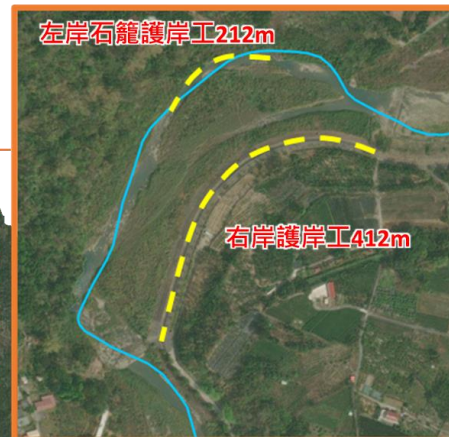
103-104年南清水溝溪王爺潭護岸段 防災減災工程(已完工)
