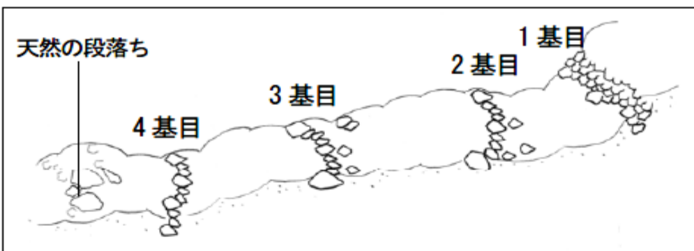
図-18 完成直後の分散型落差工配置図 (2003 年 4 月)
