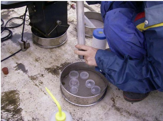
(b)以塑膠管採集方形採泥器中的底泥後，放入小痰罐中，低溫保存，攜回實驗室，進行沉積物有機、粒徑、含水量等分析
