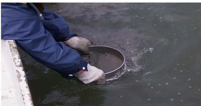
(c)將方形採泥器採集到的底泥，放入 0.5mm 的篩網中，在水面上震動過篩後，將留在篩網上的生物樣品移入標本瓶中，再以薄荷腦麻醉之，10%福馬林固定之，以進行底棲無脊椎動物之分析
