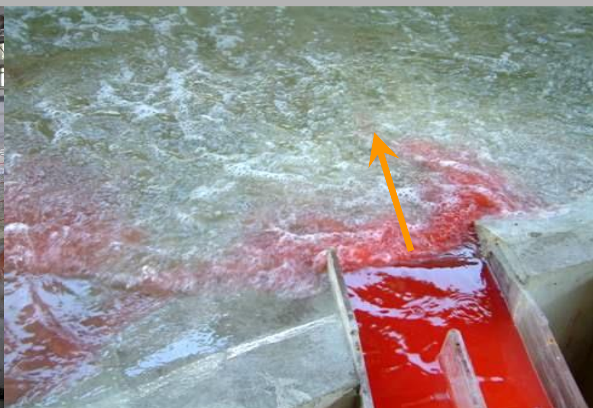
消能池出口段試驗流況
