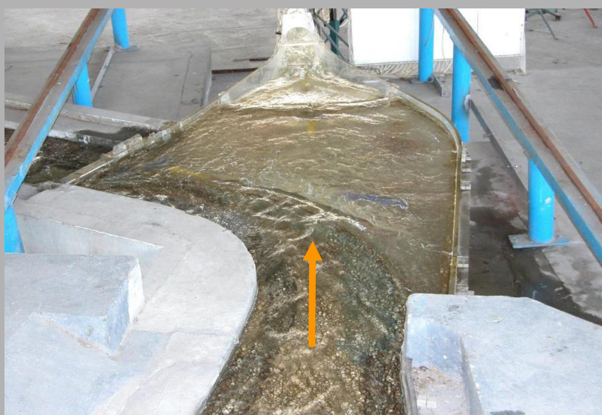
側流堰附近試驗流況
