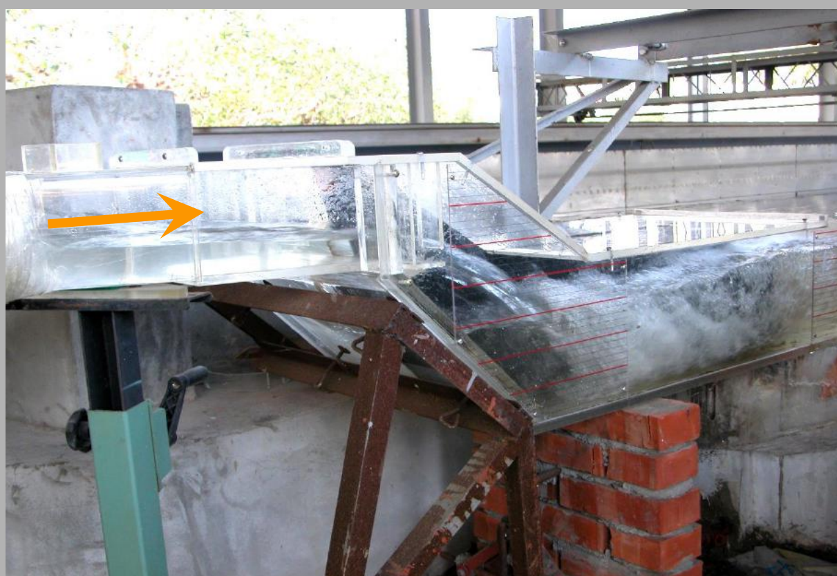
隧道出口段試驗流況
