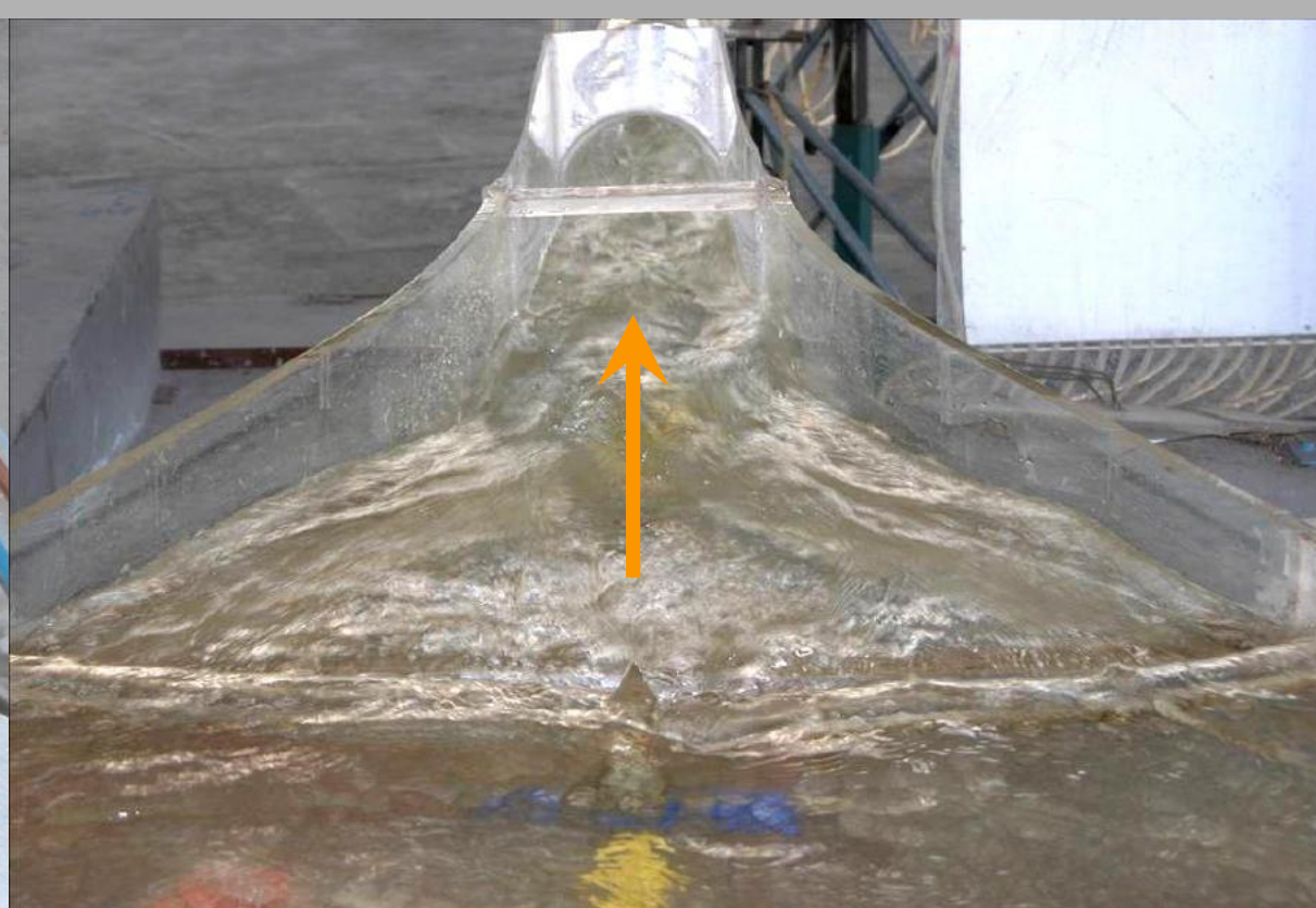
分洪堰陡坡段試驗流況
