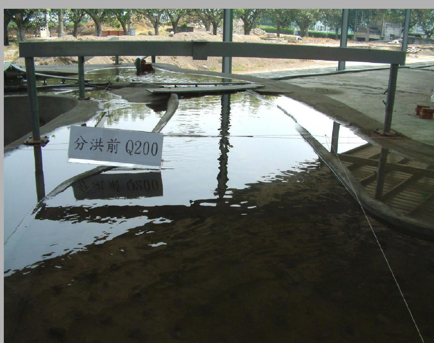
百福社區段洪水溢流情形 ( Q_{200} 未分洪試驗條件)
