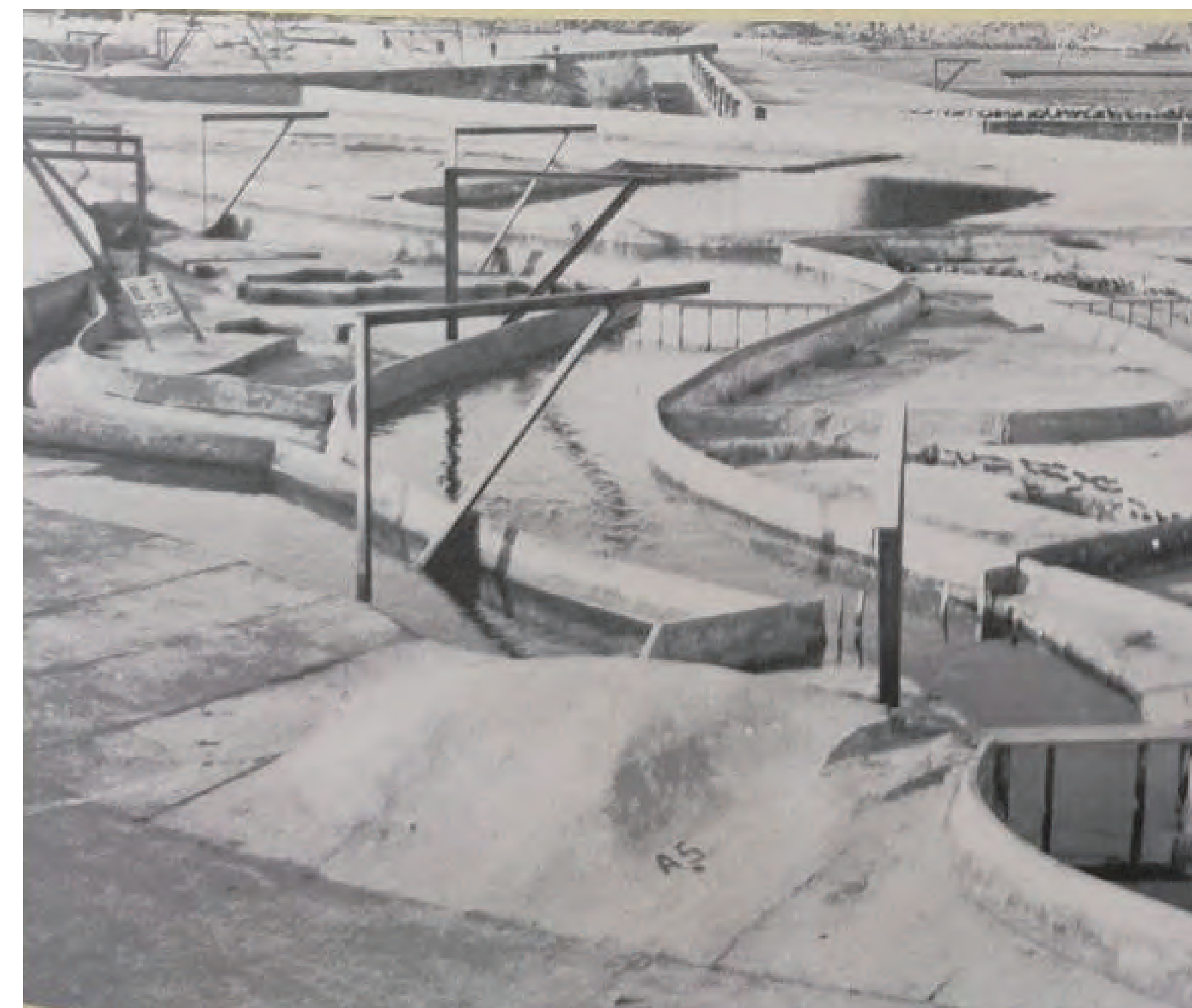
淡水河全模型布置圖 資料來源:經濟部水利署
