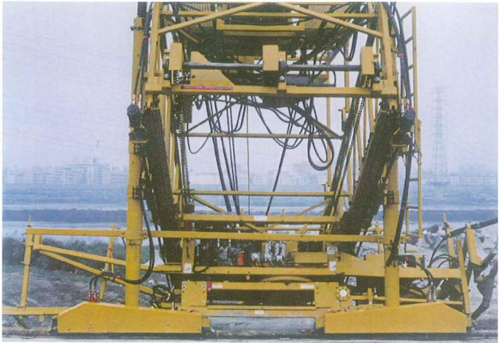
(圖三) 鋪築機及桁架調整器
