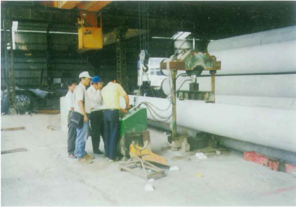
防洪工程（基樁抗彎策試）
