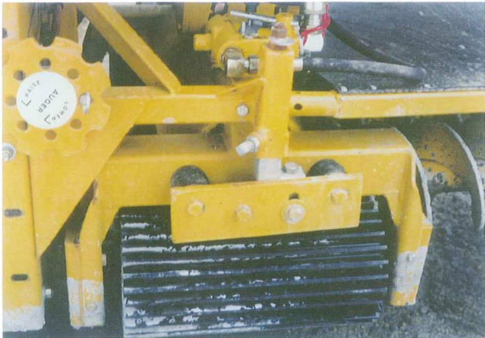
(圖八) 第一道壓實作業 (鑄式振動滾筒)
