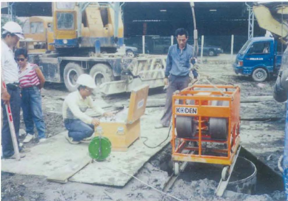
防洪工程（反循環樁紅外線策試）
