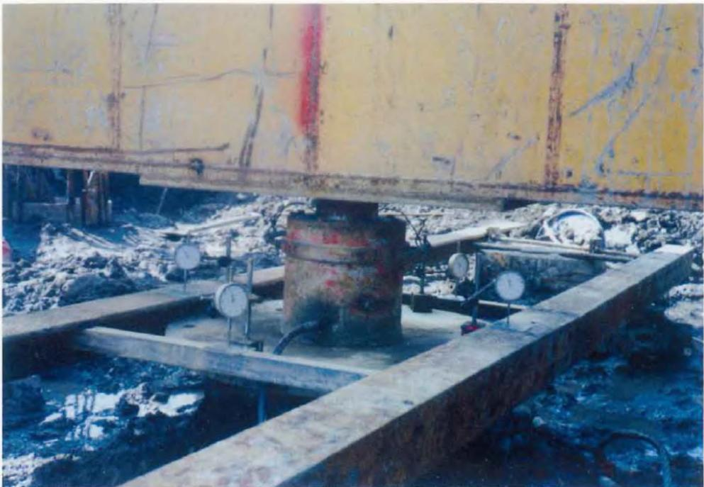
防洪工程（基樁承載力靜力策試）
