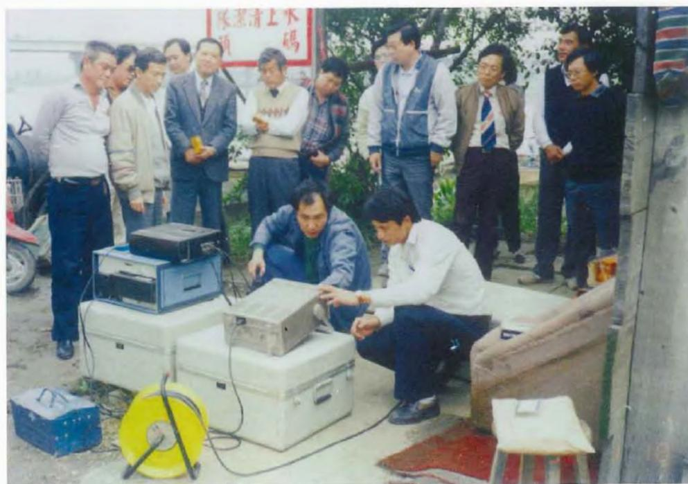
防洪工程 (基樁承載力動力策試)
