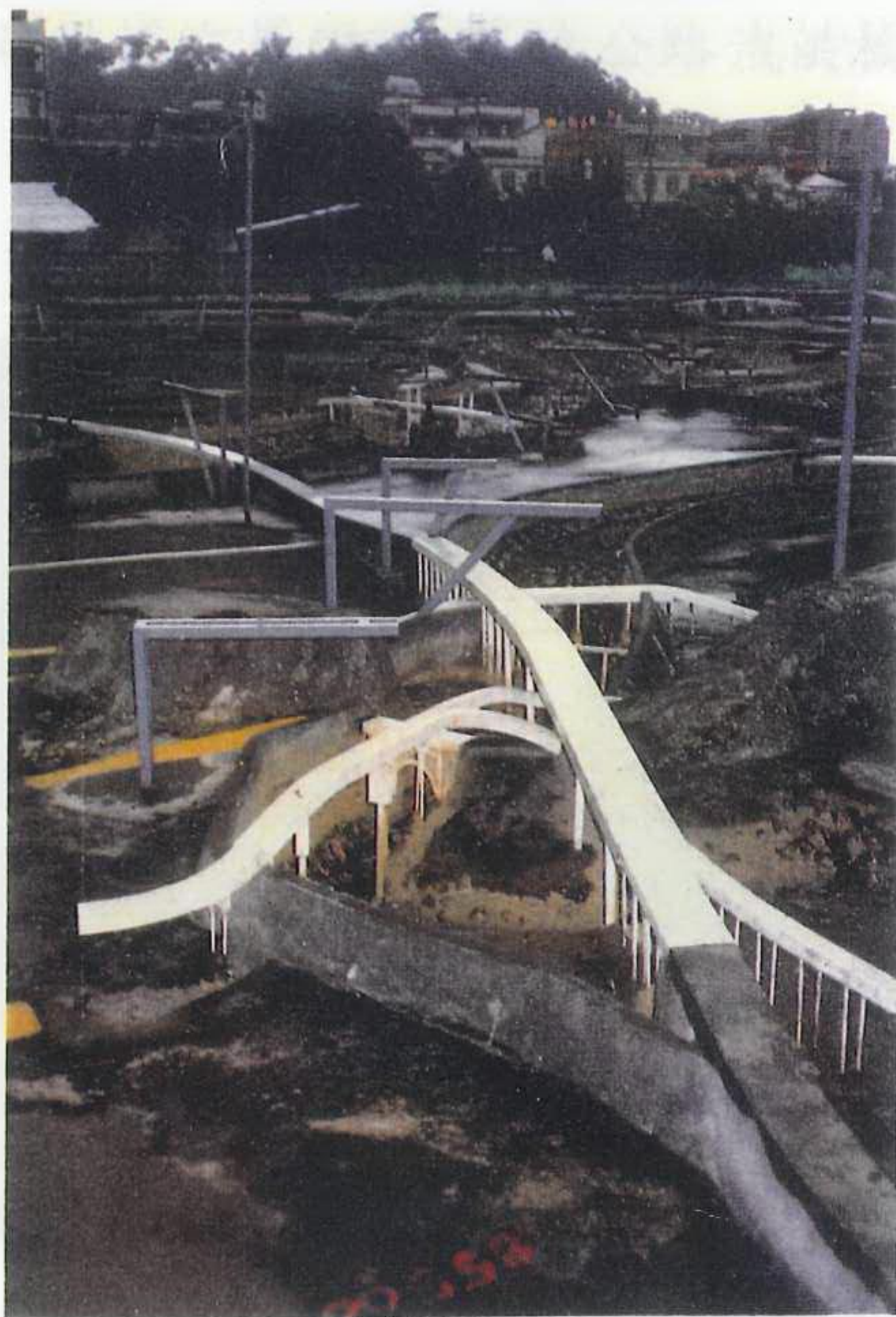
照14 溪水河水工模型基隆河中山橋河段橋墩密佈
