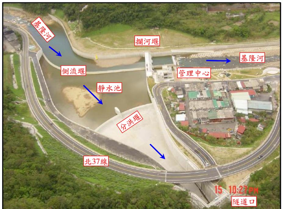
CMS 經隧道排入東海，餘流量 310 CMS 流入中下游，以維生態及水質淨化之用，其分洪結果平均可降低中下游洪水位 1.4M，發揮顯著分洪減災功效，並可避免徵收大量私地與橋樑改善，減少下游堤防工程經費。再搭配上流水土保持工作與下游防洪區段堤防工程，以流域治理、上游分洪及下游防洪、區段優先並採同步執行之方式，可讓基隆河中上游之台北縣及基隆市轄內的河段，能與下游台北市一樣達到防禦重現期距 200 年之洪峰流量保護標準，經調查可使台北縣 713 公頃、基隆市 316 公頃，合計 1029 公頃土地免受水患肆虐，並間接促進地方繁榮，保障人民生命財產安全。
