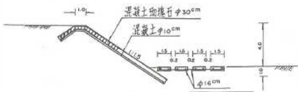
圖6-2 基隆河現有堤防護岸加高加強標準斷面圖
