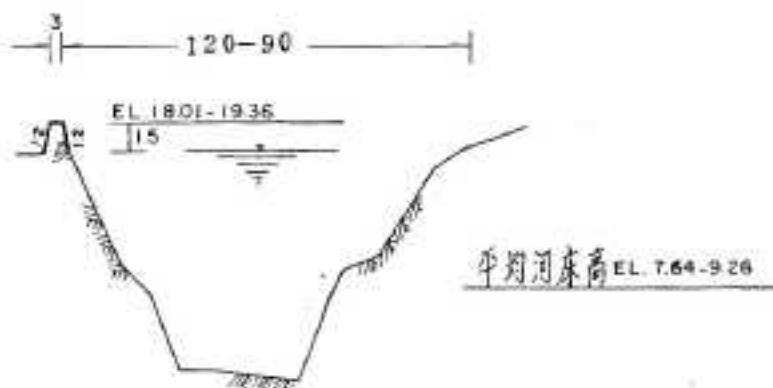
圖 5-2 基隆河各段計畫河道橫斷面圖(三)
