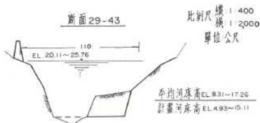
圖3-3-2 基隆河各段計畫河道橫断面圖(三)
