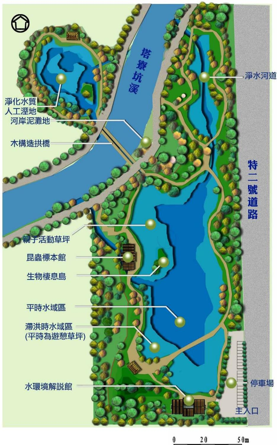
圖 7.1-11 特 2 號道路旁之生態景觀滯洪池平面配置圖
