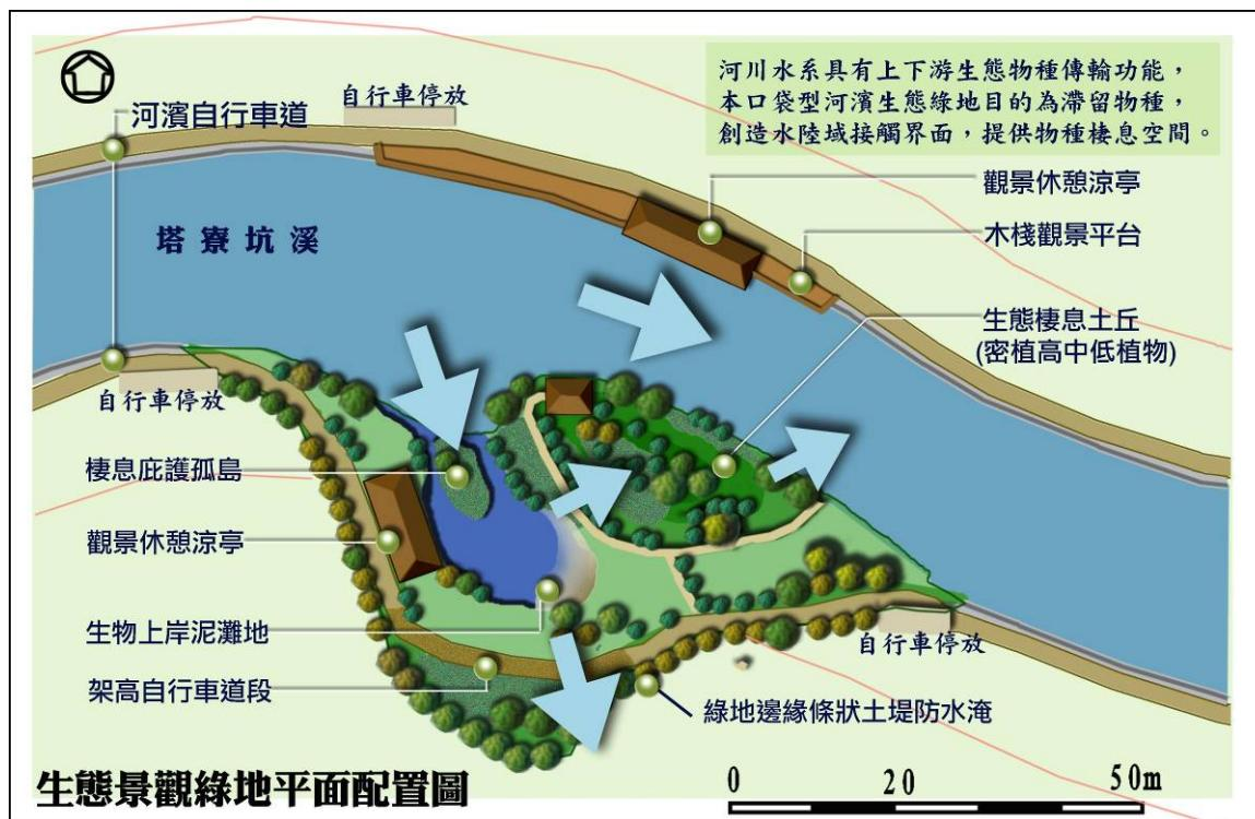
圖 7.1-13 營盤橋下游右岸堤後公有地規劃為河濱生態綠地之構想示意圖
