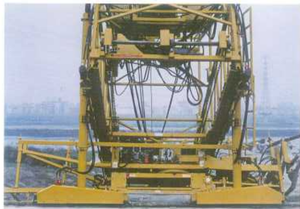
(圖三) 鋪築機及桁架調整器
