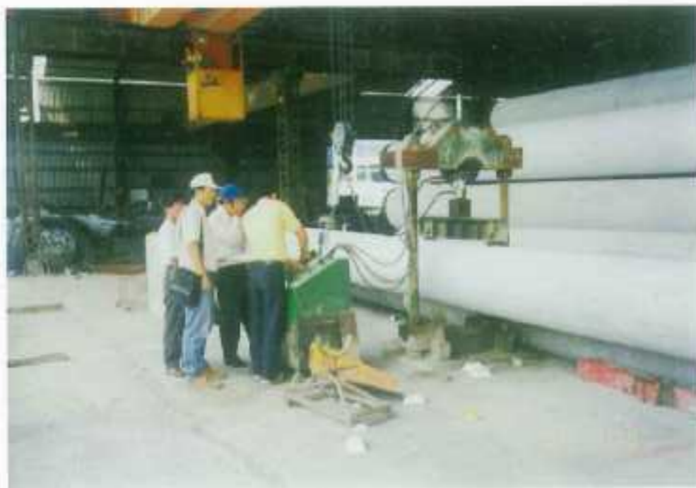
防洪工程 (基樁抗彎策試)
