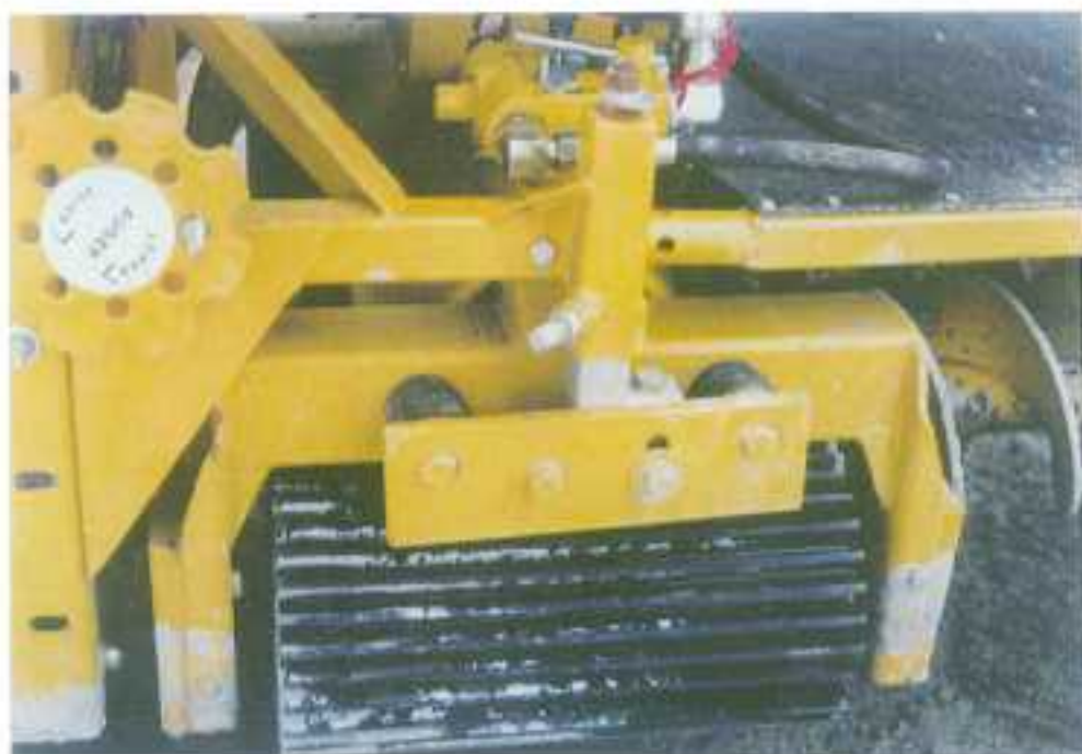
(圖八) 第一道壓實作業 (鋸式振動滾筒)
