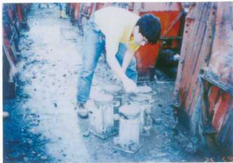
防洪工程 (混凝土試體製作)
