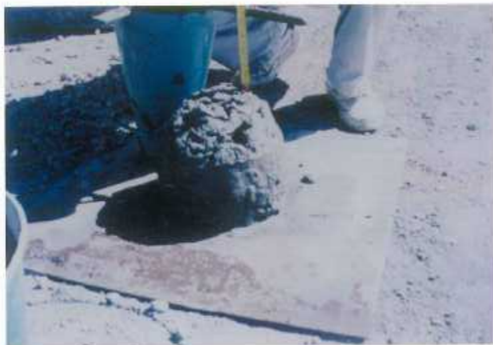
防洪工程 (混凝土坍度測驗)
