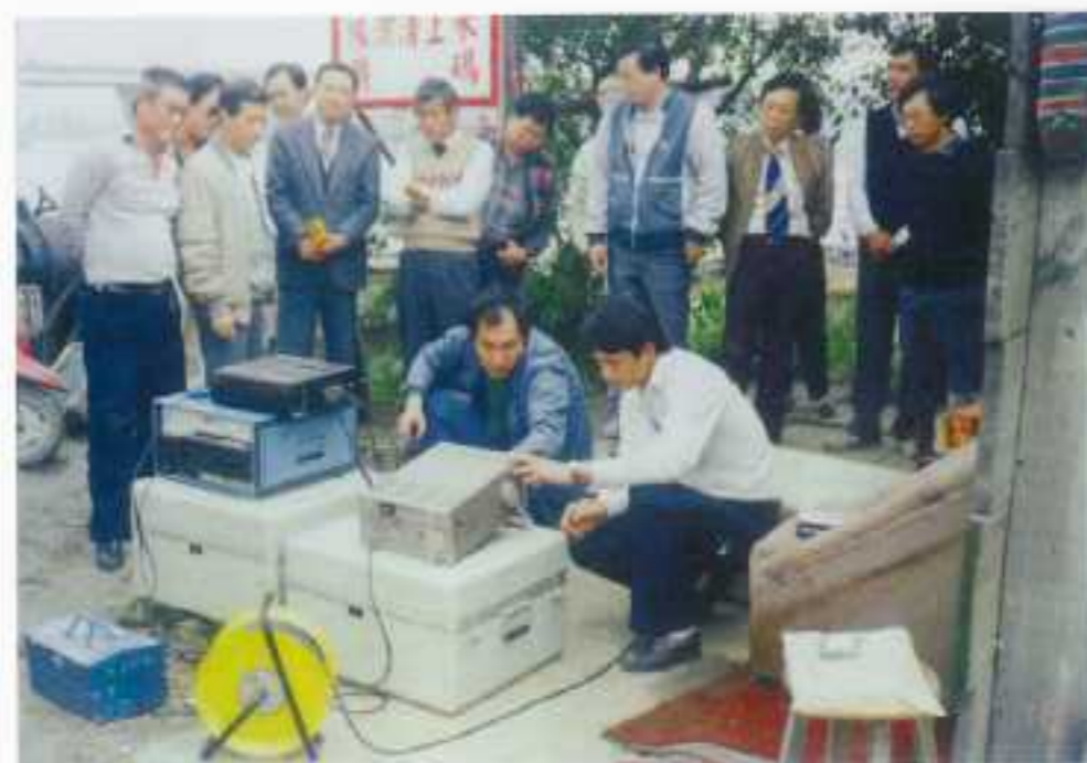
防洪工程（基樁承载力動力策試）
