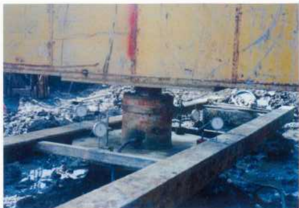
防洪工程（基樁承载力靜力策試）
