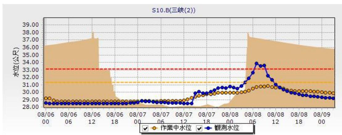
整體而言在 8/8 20:00 時間，由氣候法 75%降雨預報產品產生的預報在各水系皆有低估的現象，與下節由觀測雨量模擬結果比較，可發現其為淡水河各水系預報水位低估之主因。根據降雨預報分析，氣候法 75%降雨預報產品之 24 小時平均累積降雨量低估 100mm，降雨峰值低估 20.7mm。
