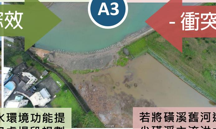
若將磺溪舊河道入口處堤段加高，減少磺溪主流洪水排除管道，造成水位上升，更不利於西勢溪排水排洪
