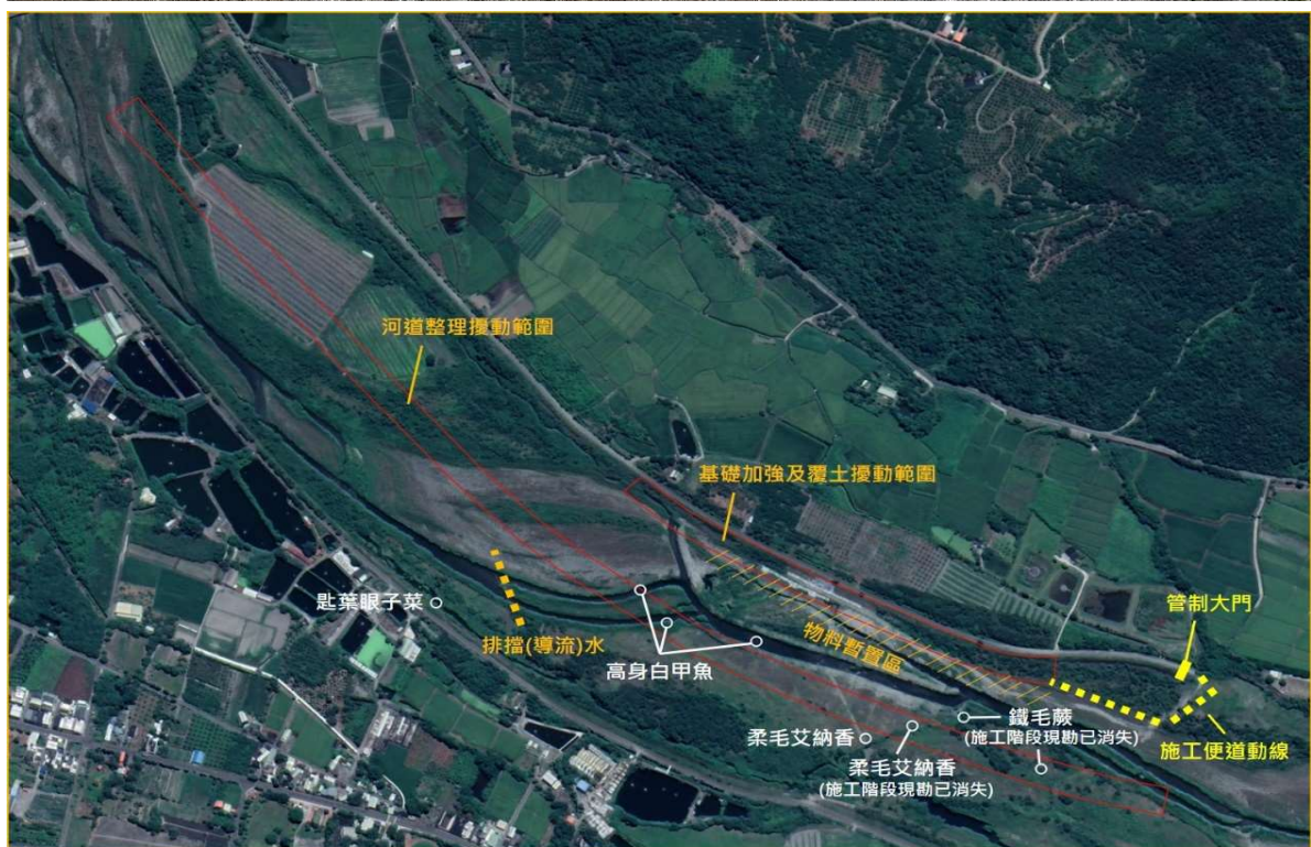
圖 1、施工前預計施工擾動範圍
