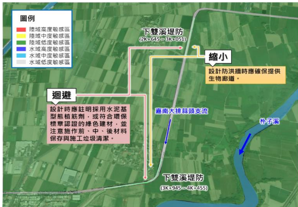
圖 65 110 年度朴子溪下雙溪蒜頭埧仔堤防構造物維修改善工程生態保育對策圖-下雙溪堤防
