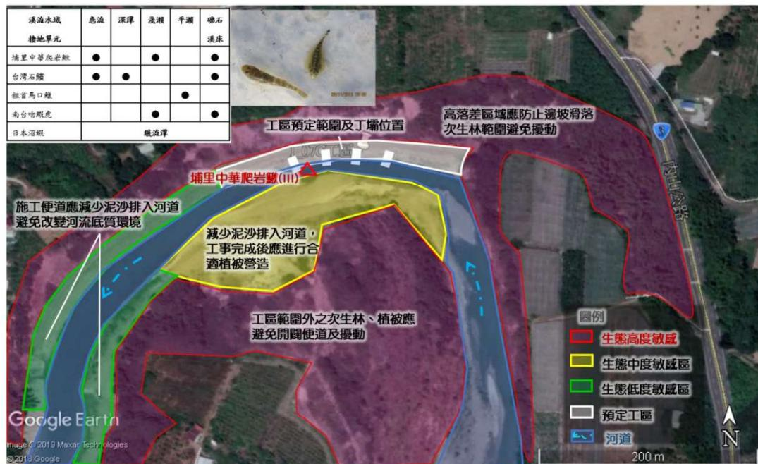
圖 5-47 後堀溪玉井大橋上游芒子芒段護岸改善工程之小尺度生態關注區域圖
