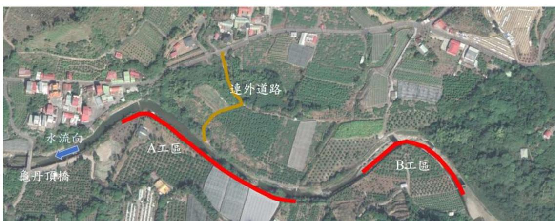
圖 4-74 後旦溪龜丹橋上游段整體改善工程工區位置圖
