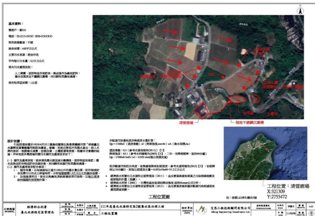
圖 6-1 施工區域施工道路配置平面圖
