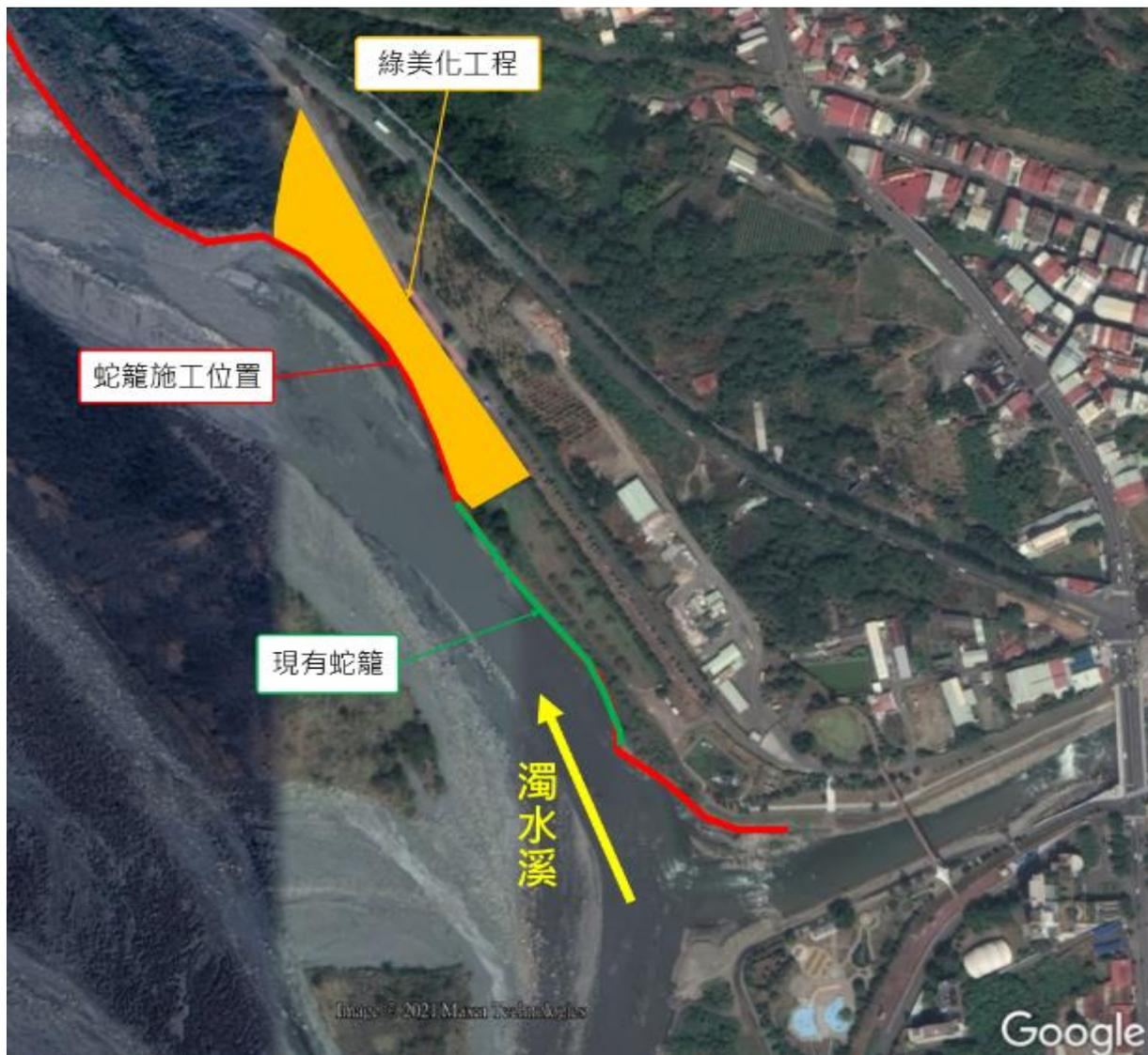
圖 4-2 濁水溪水里堤防段改善工程施工位置圖
