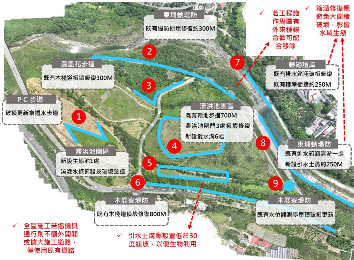
圖 4-6 正射圖與工程配置圖
