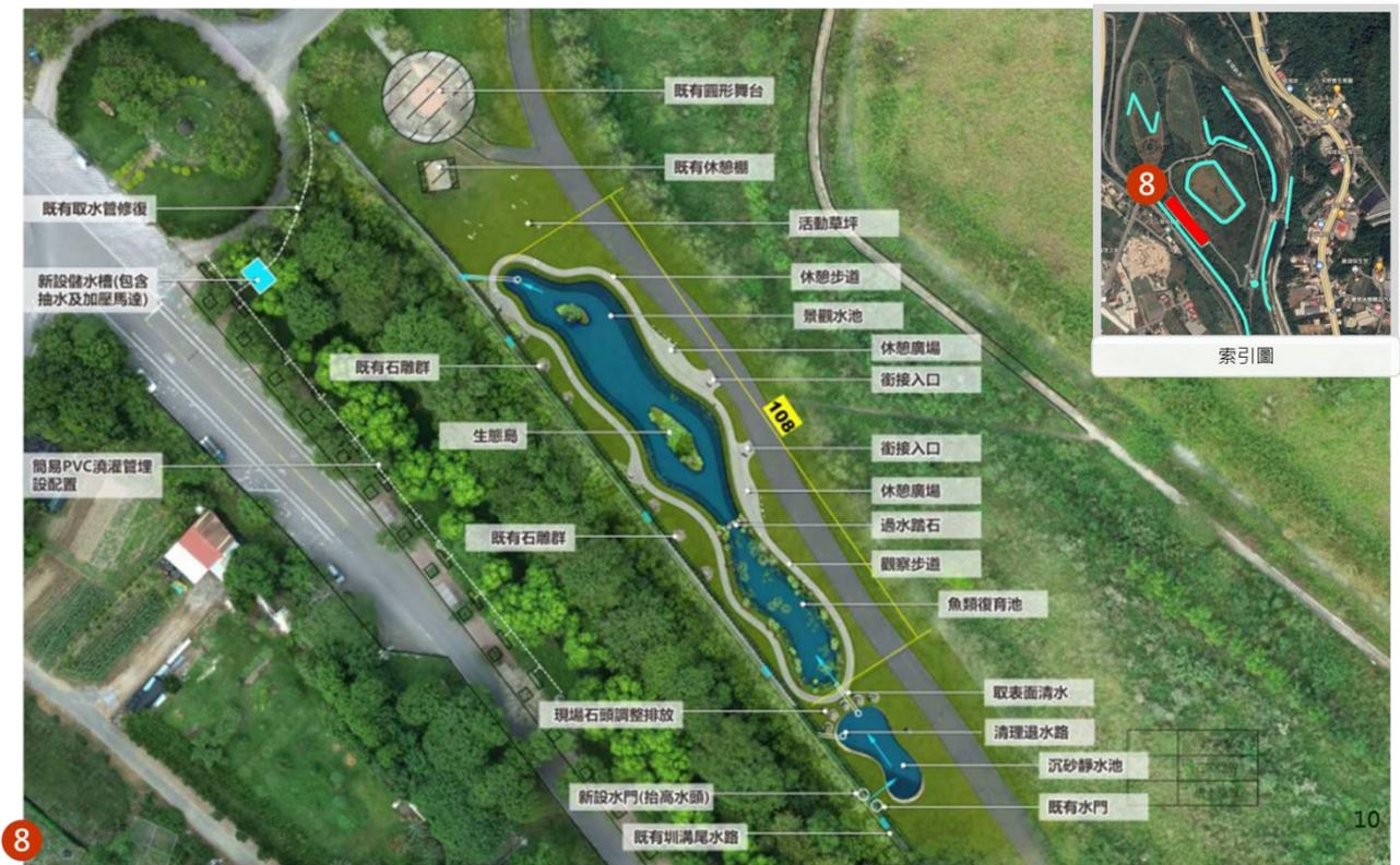
圖 4-2 新設生態池平面示意圖
