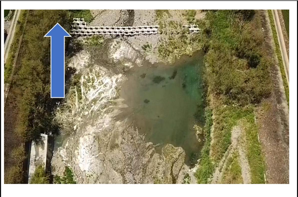
既有可卸式河道坡降調整工（2021 搶災搶險堆放）上游出現大面積積水，猜測是河床整地不均。
