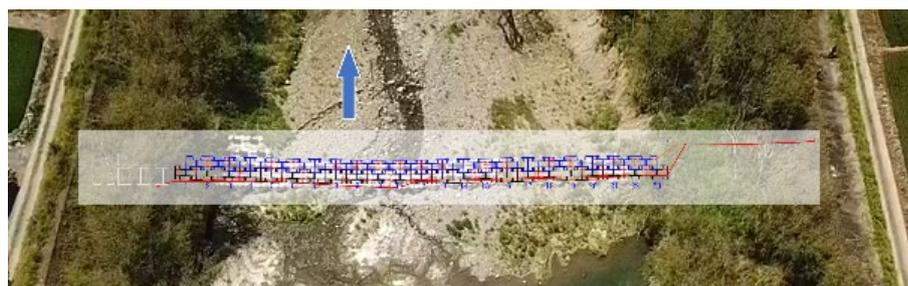
圖 5.2-7 (0+600 處)固床工及整底施工範圍
