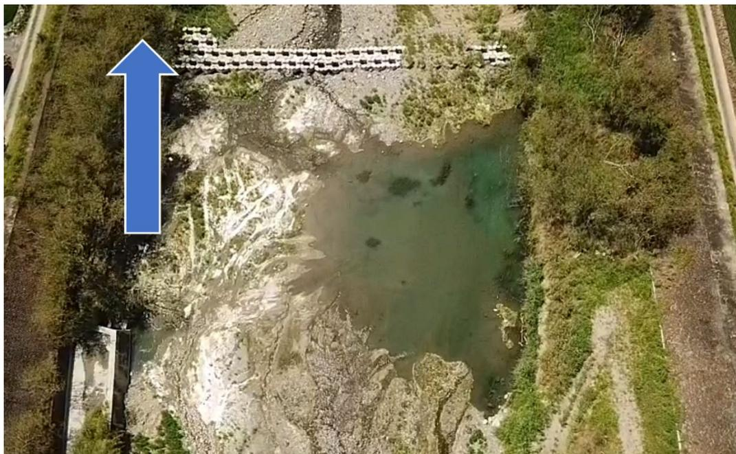
圖 5.2-3 臨時固床工上游出現大面積積水
