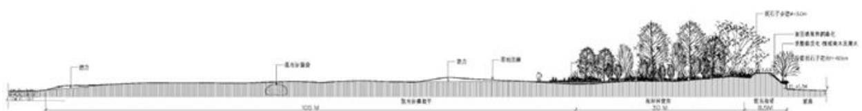
圖 6-51 塹豐海堤改善斷面圖-C-C' (方案一、二)
