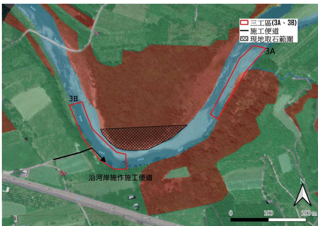
圖 4.2-20 後崛溪三埔及壽保段護岸整體改善工程三工區便道打設及現地取石預定位置
