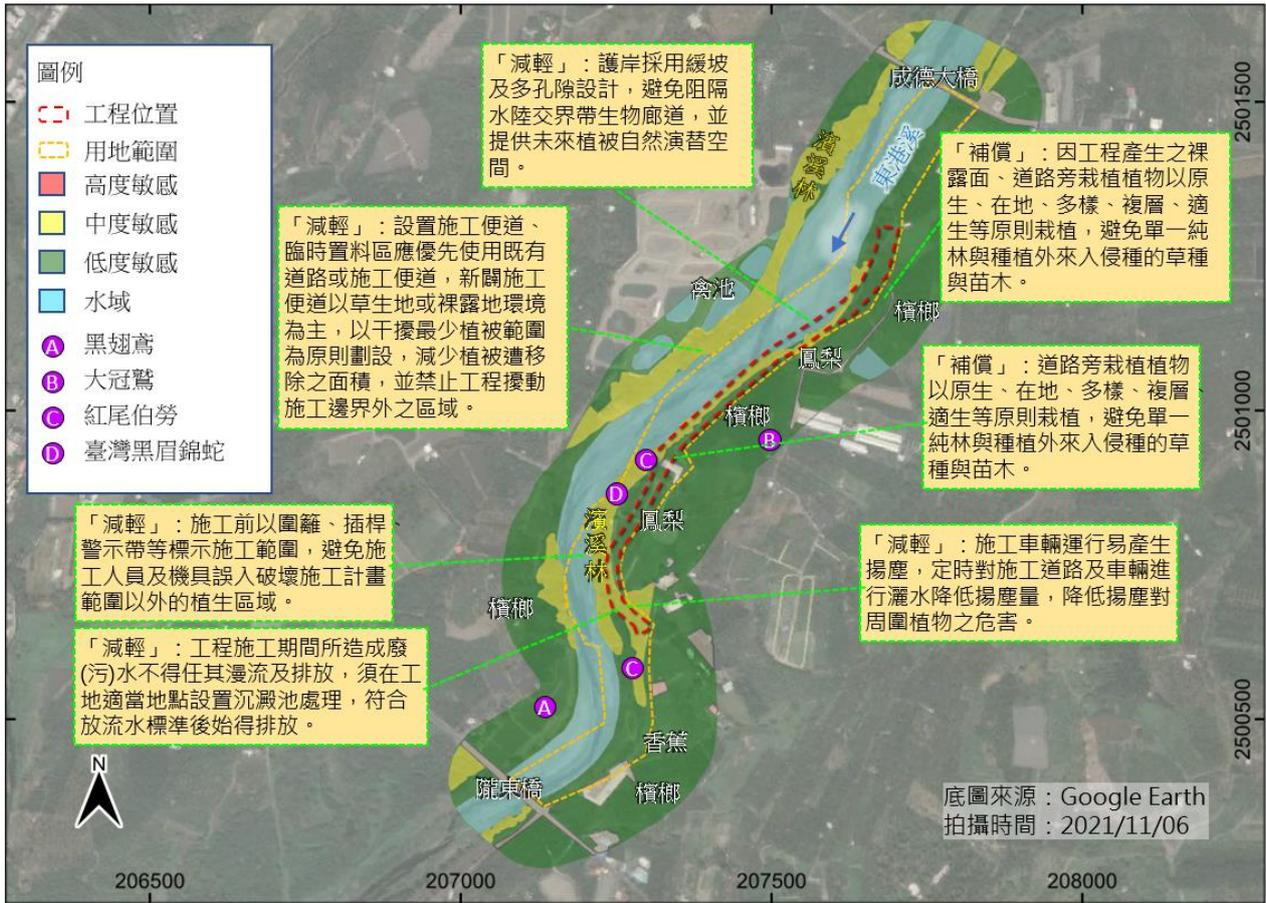
圖 1-2 東港溪隴東橋上游護岸段改善工程生態保育措施平面圖
