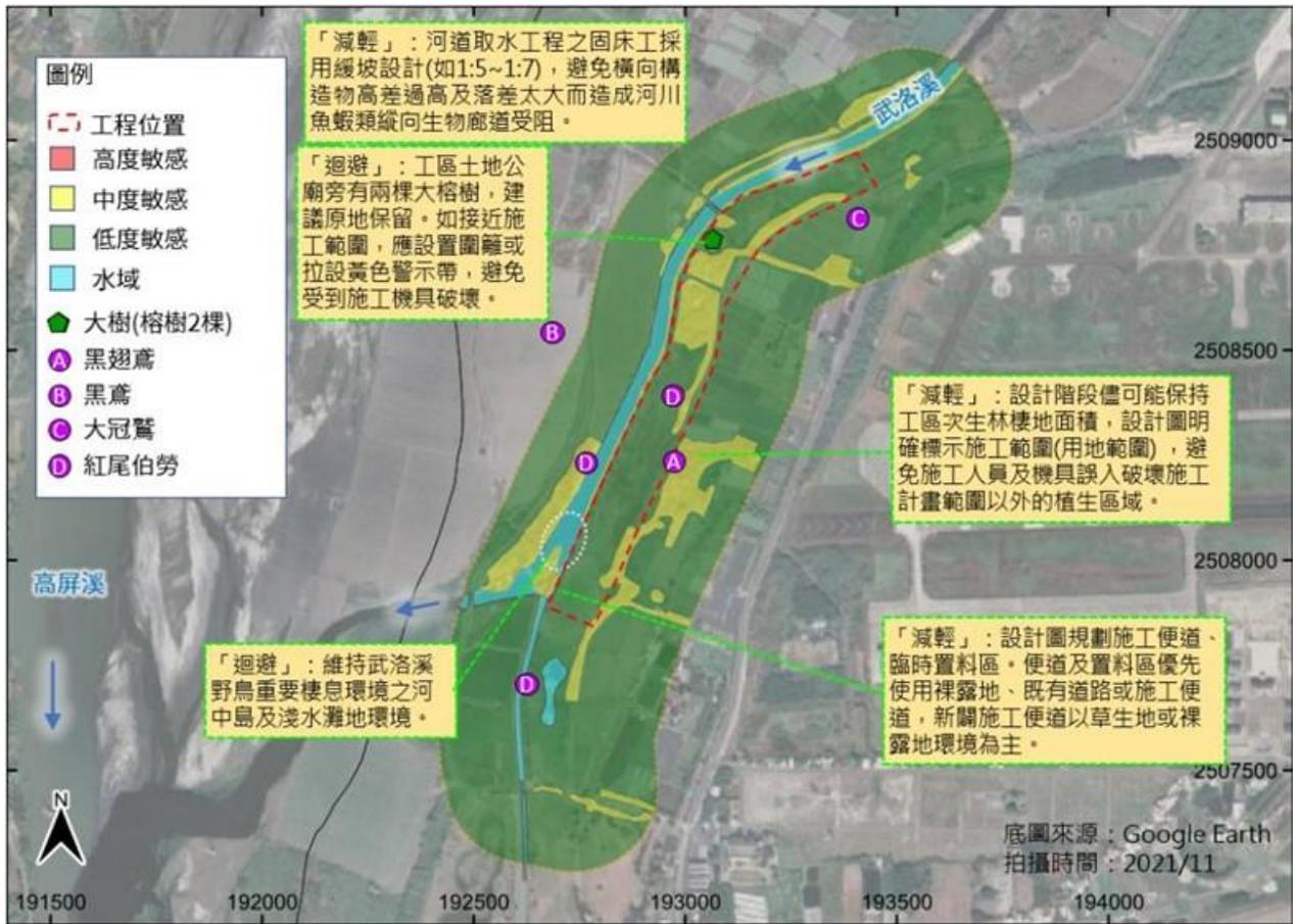
圖 1-4 高屏溪武洛溪排水段整體環境營造工程生態保育措施平面圖
