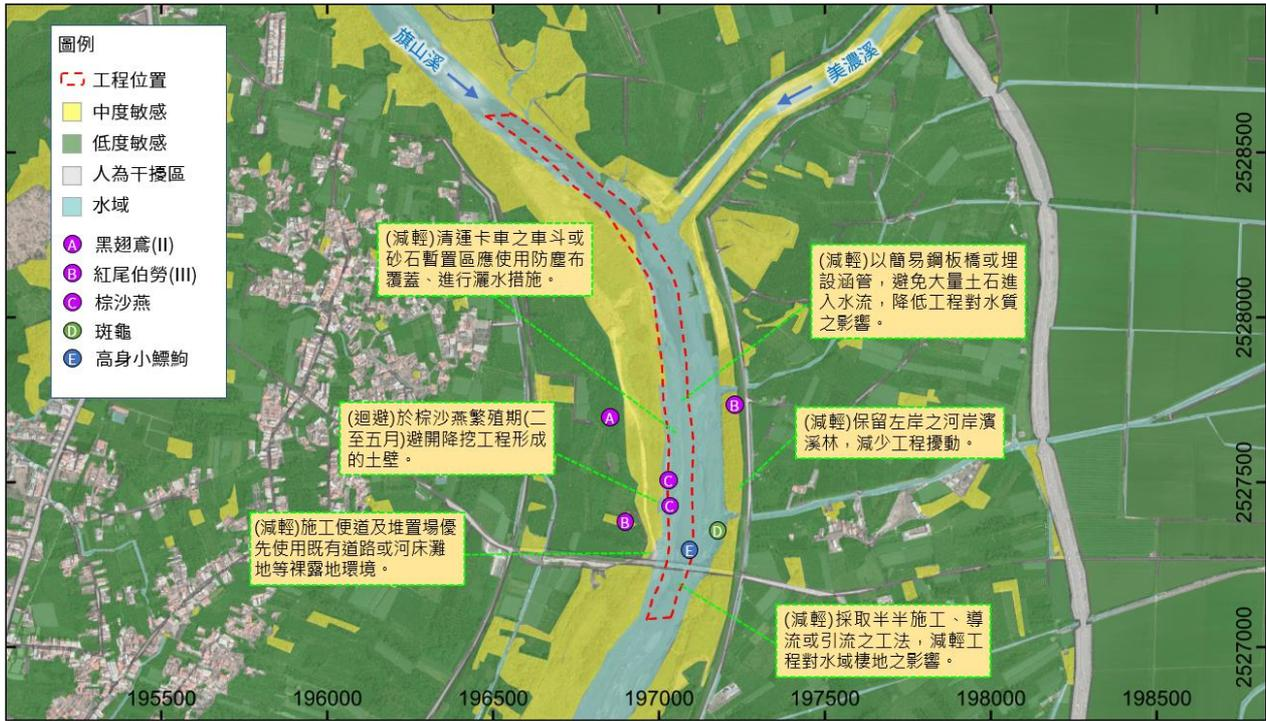
圖 1-2 旗山溪溪洲大橋上游河段河道整理工程生態保育措施平面圖
