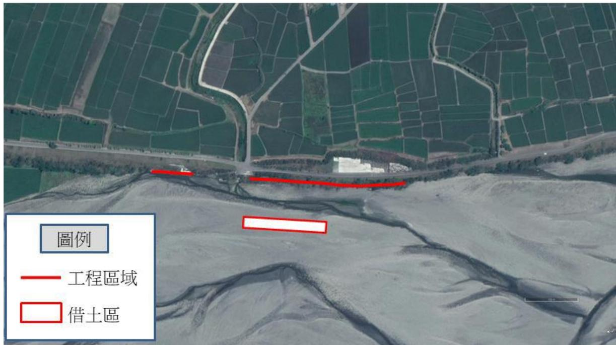
圖 2-2 卑南溪電光二、三號堤防基礎保護工加強工程範圍
