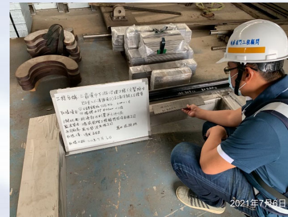
水閘門母材取樣
