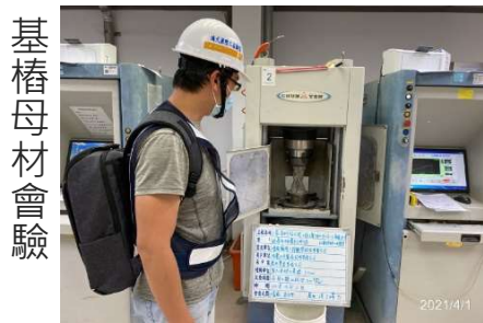
基樁母材取樣
