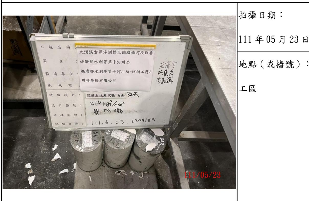
說明：圓柱試體抗壓試驗
