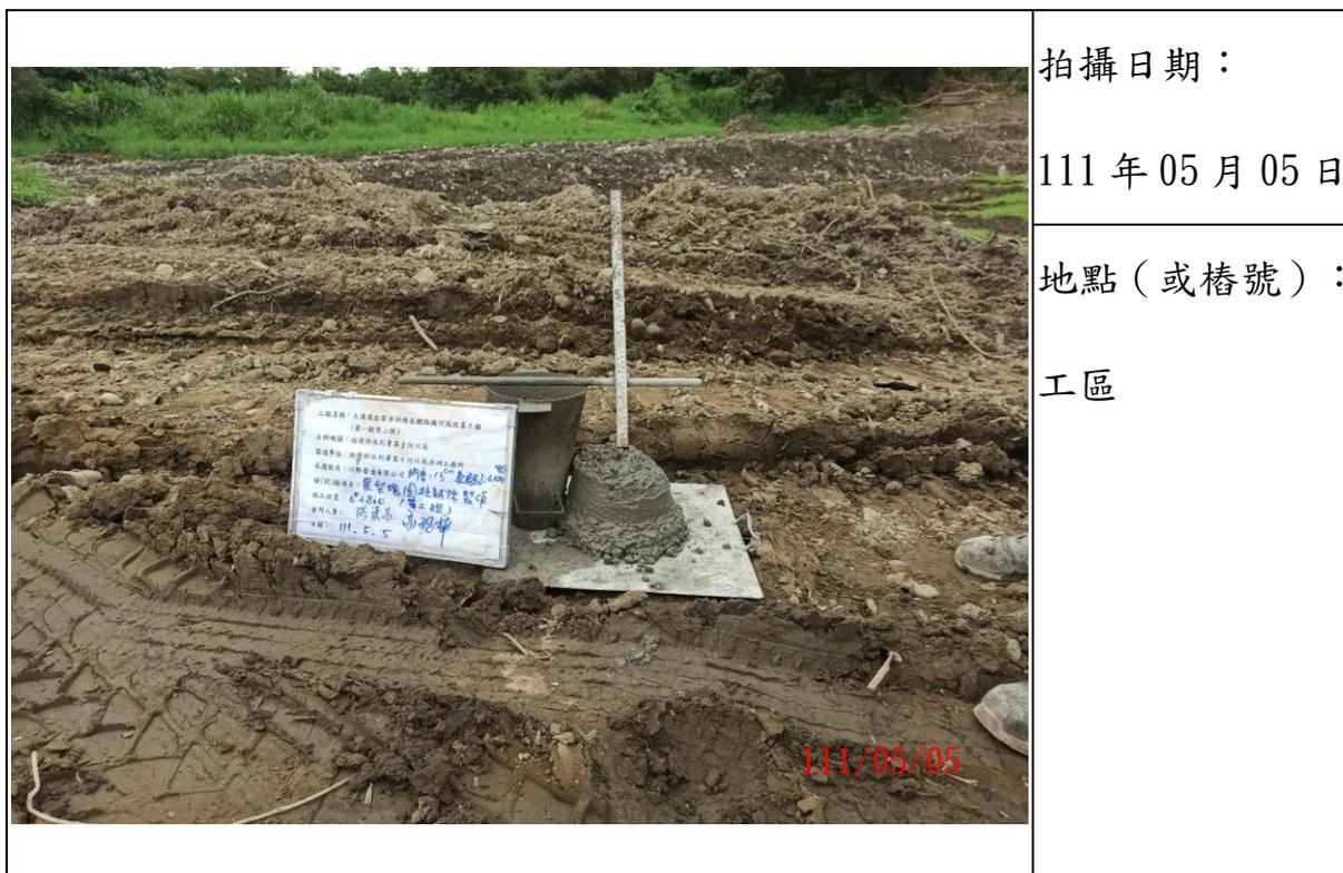
說明：異型塊混凝土圓柱試體製作-坍度
