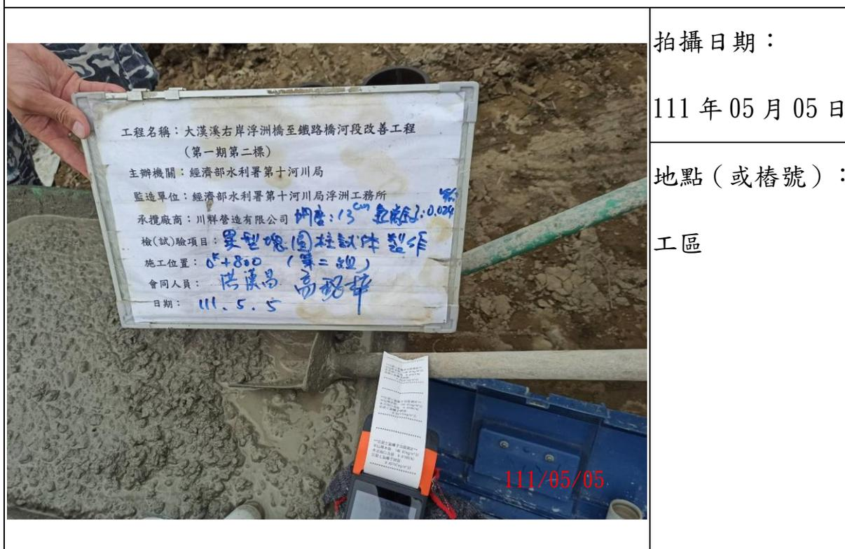
說明：異型塊混凝土圓柱試體製作-氯離子濃度
