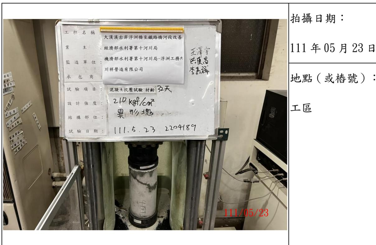
說明：圓柱試體抗壓試驗
