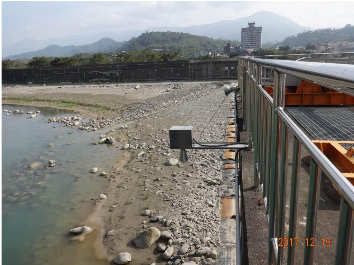
圖 6.1：監測儀器檢查-水位計(雷達波)
