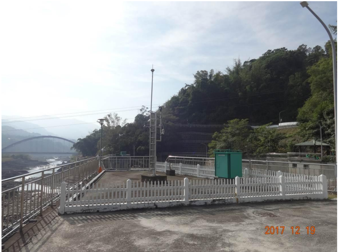
圖 6.3：監測儀器檢查-氣象站
