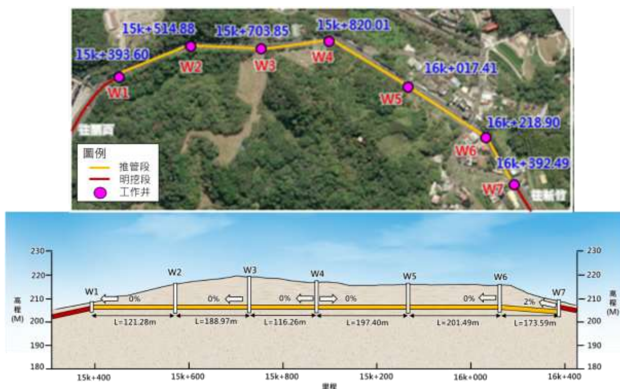
圖 7-28 里程 15k+393.60~16k+392.49 推進段平剖示意圖
