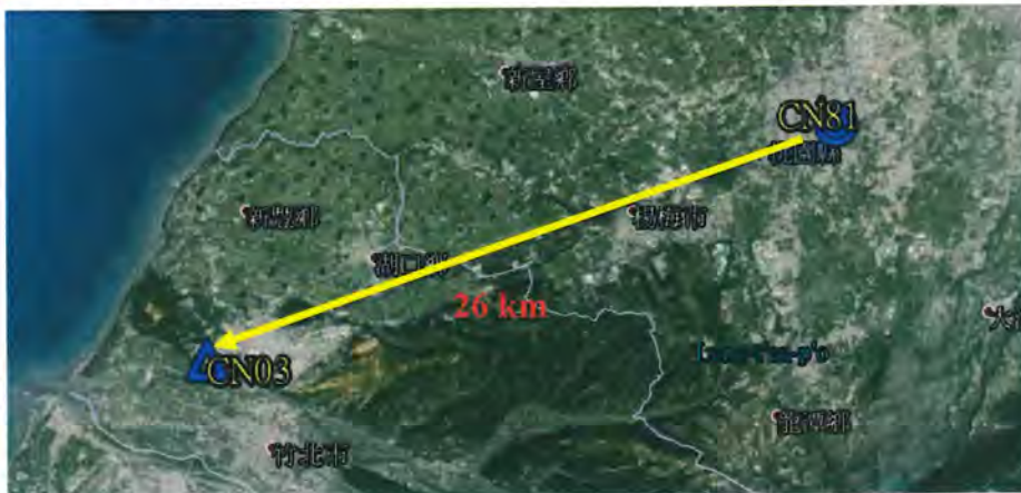
圖 1 固定式校正基點 CN81 至追蹤站 CN03 校正場示意圖
